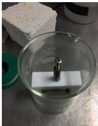
治具の突出部をアセトン洗瓶中 洗浄中、突出部に跳ね返った アセトンが眼に入る
