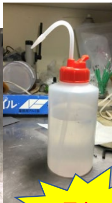
治具の突出部をアセトン洗瓶中 洗浄中、突出部に跳ね返った アセトンが眼に入る
